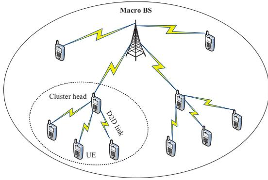
Fig. 1. D2D multicast communication scenario.
